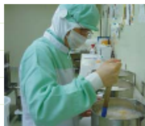
時間、回転数、スピードなど詳細レシピに基づく手作業によるミキシング
